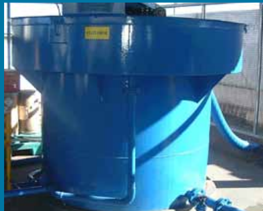
Figura 5.1 - Flotador que realiza a separação do sólido da água
