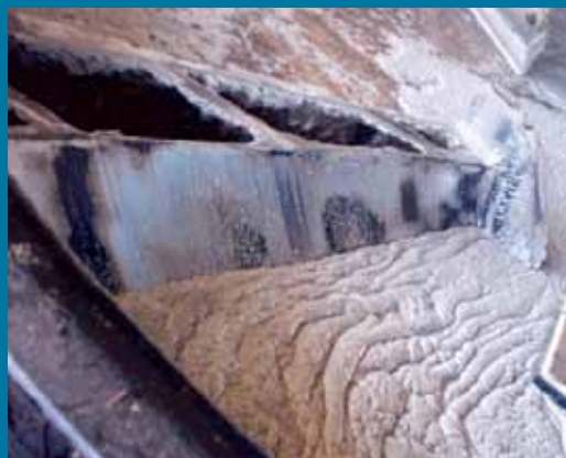
Figura 5.2 - Parte interna superior do flotador; sólidos mais gorduras sendo separados da água.
